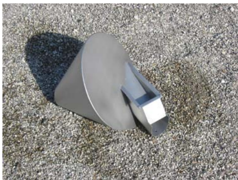
Fot. 2.21. Przykład regulatora z przepływem wirowym
