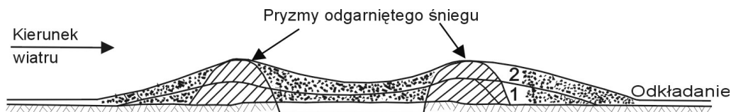
Rys.6. Nawiewanie i odkładanie się śniegu na drodze w terenie płaskim
